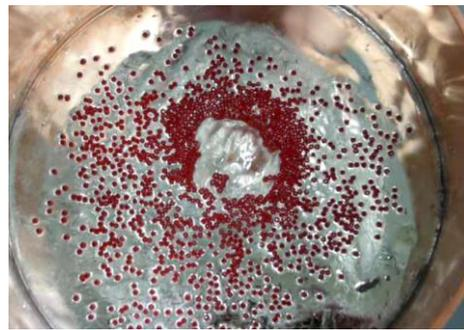
Fig. 13: Particle “slag” distribution;  $h_0=20\text{mm}$ ,  $I_{\text{rms}}=1000\text{A}$
